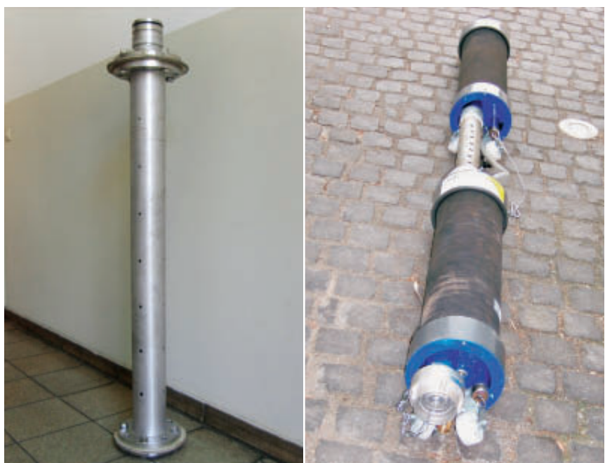
Abb. 1: Einfache Manschettenkammer (links) und symmetrische Doppelkolbenkammer in der Prototyp I-Version für den Einsatz in Horizontalfilterbrunnen (rechts)
