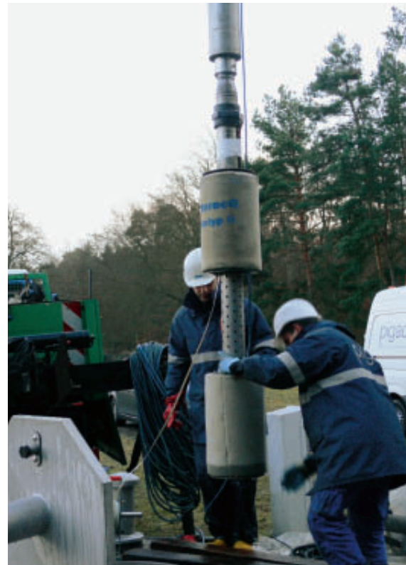
Abb. 8: Symmetrische Doppelkolbenkammer in der Version Prototyp II für den Einsatz in Vertikalfilterbrunnen DN 300 zur Intensiventnahme mit gemantelter Tauchmotorpumpe am Brunnen 10 Rathenow
